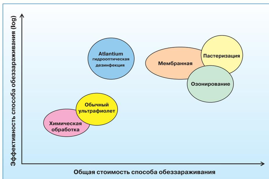
Преимущества установки в состоит в том, что можно обрабатывать большие объемы воды, установка не занимает много места, проста в эксплуатации и отсутствуют риски для безопасности обслуживающего персонала (в отличие от озонирования или химической обработки). На нашем предприятии используется гидрооптический обеззараживатель R-200 от компании Atlantium Technologies (Израиль). Оборудование было поставлено компанией «Ак-
